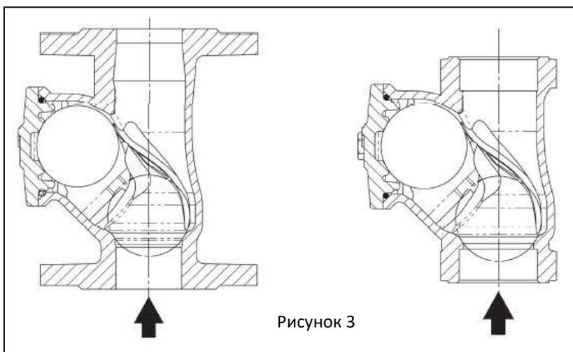
**ВНИМАНИЕ.** Клапан должен быть установлен в соответствии с направлением стрелки, показывающей направление потока рабочей среды, указанной на корпусе клапана.
